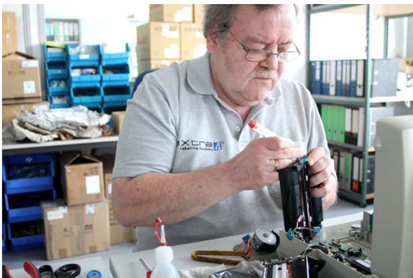
Abb.2: eXtra4-Techniker Hartmut Kasper zerlegt einen reparaturbedürftigen Thermotransfer-Etikettendrucker
